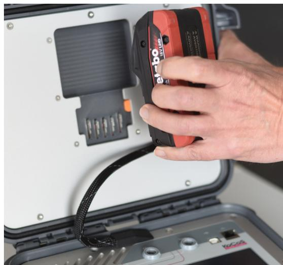
Abb. Wechselbarer Akku
