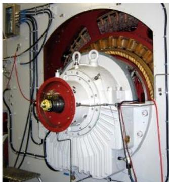
Probleme an induktiven Komponenten können elektrische Ursachen haben, wie beispielsweise Fehler an Wicklungen. Windungsschlüsse sind bei mehrphasigen Maschinen durch einen Vergleich der Eigenschaften der Wicklungen festzustellen. Der Widerstandswert sollte sich bei Wicklungen im Niederohmbereich bewegen. Große Unterschiede zwischen den Wicklungen oder große Widerstandswerte weisen auf Probleme hin. Wicklungen können beschädigt, wie zum Beispiel verbrannt, oder unterbrochen sein.
