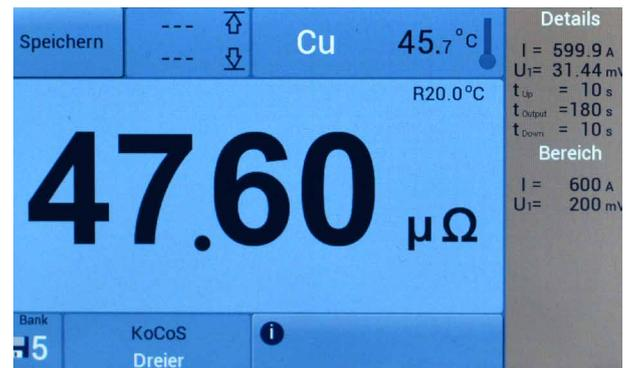
Abb. 5: Messergebnis mit nicht kompensiertem und auf 20 °C kompensiertem Wert
