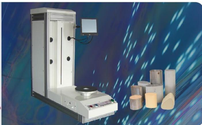
**Allgemeine Beschreibung** Optische Mess- und Formprüfsysteme zur Bestimmung von geometrischen Parametern an Monolithen und montierten Abgaskatalysatoren. Zur Qualitätssicherung und zur Steuerung des Fertigungsprozesses werden die geometrischen Parameter des Monolithen und des Blechmantels, der Spalt zwischen Monolithen und Mantel sowie optional die Mattendichte GBD berührungslos ermittelt. Die Bewertung anhand der hinterlegten Sollkontur und Toleranzen erfolgt automatisch.
