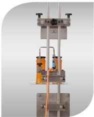
Soporte con accesorios para el sensor de vacío y la unidad de barrera de luz.
