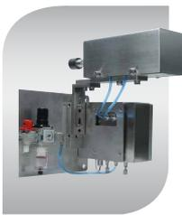
Behälter, die von einem Prüfsystem als fehlerhaft erkannt wurden, können mit der Auswerfereinheit aus dem Produktfluss ausgeschleust werden. Die Steuerung und die Anpassung an die Behälterparameter erfolgen über die Zentraleinheit.
