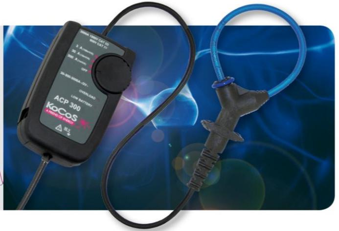
Der Stromsensor ACP 300 kann in Verbindung mit dem Netzanalysator EPPE zur Wechselstrommessung bis zu 300 A eingesetzt werden. Eine 3-Stufen-Messbereichswahl ermöglicht eine genaue Messung bei hohen wie auch bei niedrigen Strömen. Der flexible Messkopf ermöglicht eine Strommessung auch an schwer zugänglichen Stellen und dient zur Messung an Leitern wie Kabeln oder Stromschienen. Der Sensor wird über das angeschlossene Messgerät versorgt und liefert ein Spannungsausgangssignal bis zu 3 V.
