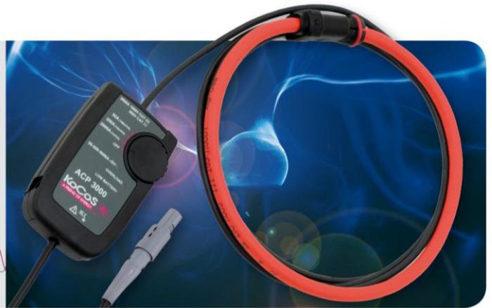
Der Stromsensor ACP 3000 kann in Verbindung mit dem Netzanalysator EPPE zur Wechselstrommessung bis zu 3000 A eingesetzt werden. Eine 3-Stufen-Messbereichswahl ermöglicht eine genaue Messung bei hohen wie auch bei niedrigen Strömen. Der flexible Messkopf ermöglicht eine Strommessung auch an schwer zugänglichen Stellen und dient zur Messung an Leitern wie Kabeln oder Stromschienen. Der Sensor wird über das angeschlossene Messgerät versorgt und liefert ein Spannungsausgangssignal bis zu 2 V.
