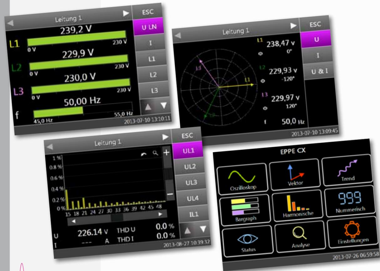
Grenzwertverletzungen und Störschriebe können beim EPPE PX direkt am Display angezeigt und analysiert werden, was eine Vorort-Analyse an der Messstelle auch ohne PC ermöglicht.
