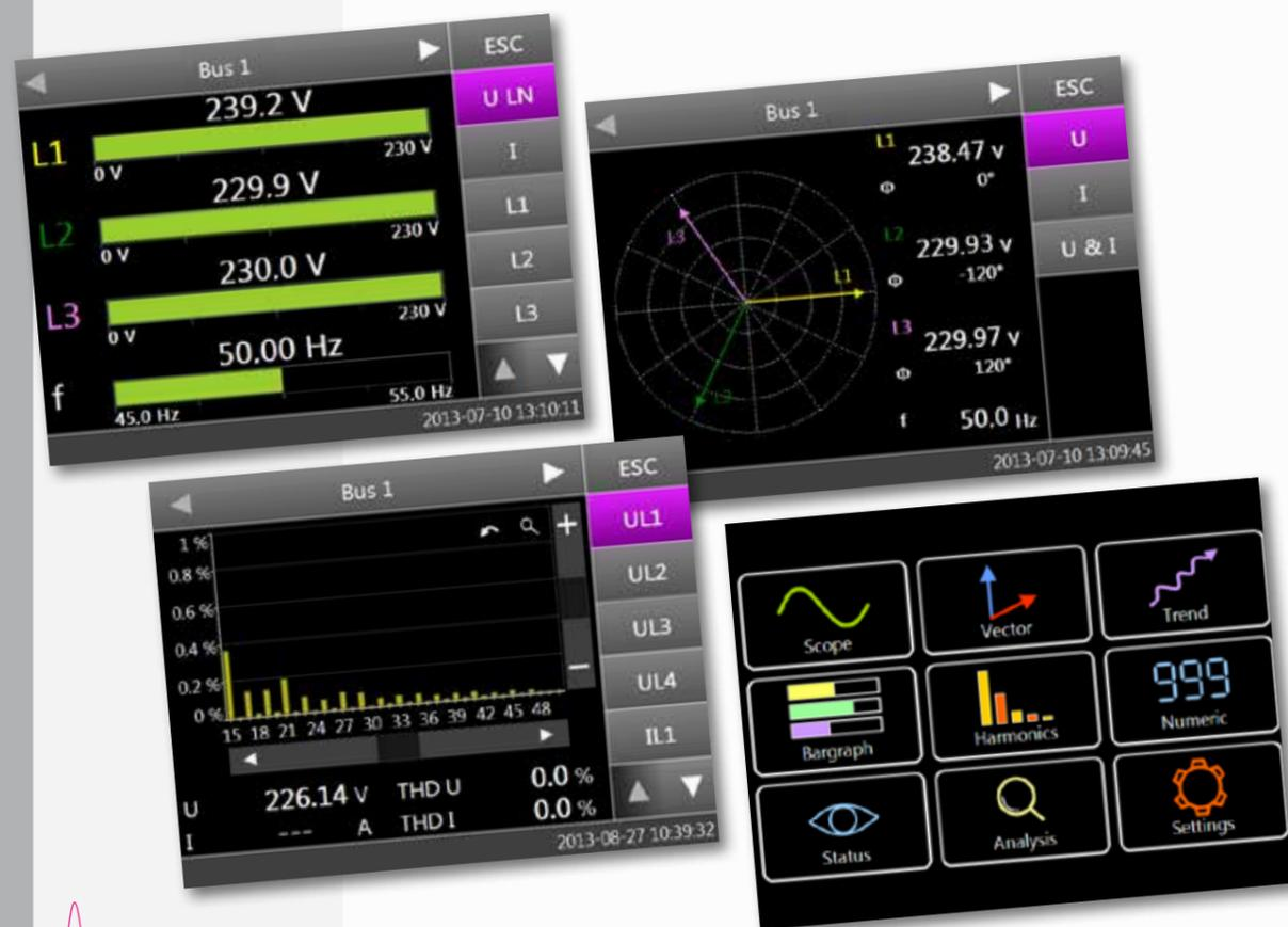
Sur l'EPPE PX, les dépassements de valeurs limites et enregistrements de défaut peuvent être affichés et analysés directement sur l'écran, ce qui permet l'analyse sur le site de mesure, même sans PC.
