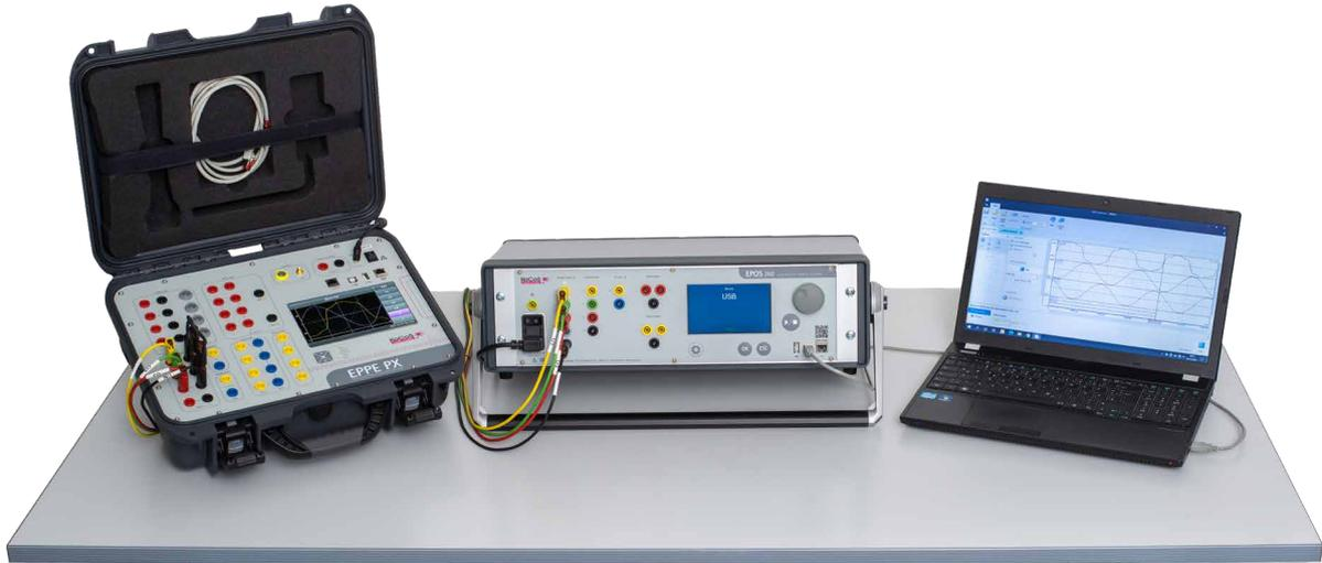
Bild 10: System zur Überprüfung des Signalgenerators EPOS 360 mit dem Netz- und Energiequalitätsanalysator EPPE PX
