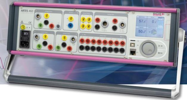
**Anwendungen** Hochpräzises, portables Messsystem für die Funktionsprüfung verschiedener Schutzeinrichtungen. Vier Spannungs- und sechs Stromausgänge ermöglichen die dreiphasige Prüfung von statischen und digitalen Relais sowie von Differentialschutzrelais. Analoge Messeingänge bieten darüber hinaus die Möglichkeit, auch Messwertumformer zur prüfen und zu kalibrieren.
