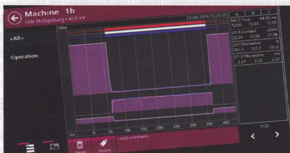
Fig. 3: Monitor de análisis como medidas DRM. Medidas regulares de la Resistencia estática y dinámica del contacto permiten una evaluación precisa de la condición de todo el sistema de contactos
