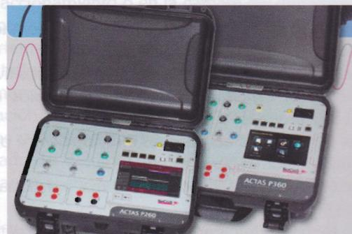
Fig. 4: ACTAS P260 (izquierda) y ACTAS P360. Los sistemas de prueba portátiles de alta precisión pueden llevar a cabo pruebas de varios tipos de interruptores, incluyendo circuit breakers, seccionadores, o puestas a tierra, independientemente del tipo de unidad.
