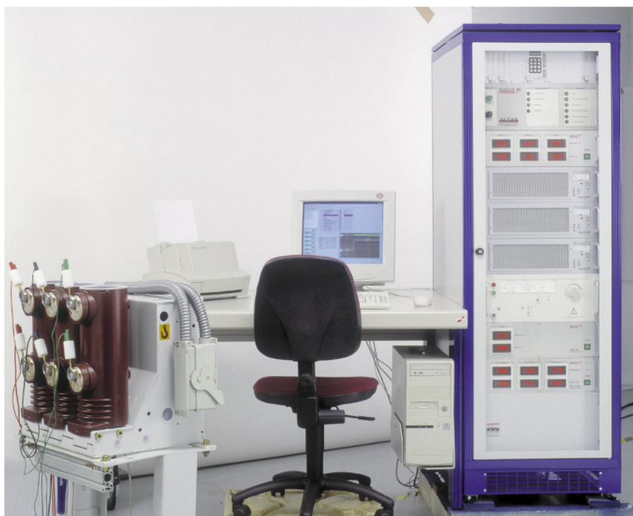
Bild 1. Prüfstation für die Schalterprüfung an Hochspannungsschaltern „ACTAS C16“
